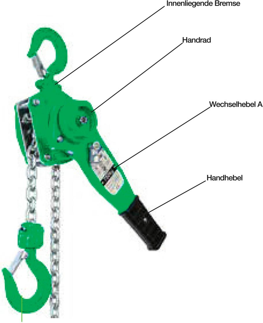
Falls die Kette ausgewechselt werden muss, so steht zu vermuten, dass auch die Kettennuss in Mitleidenschaft gezogen worden ist. Auch diese ist auf Verschleiß zu prüfen.
